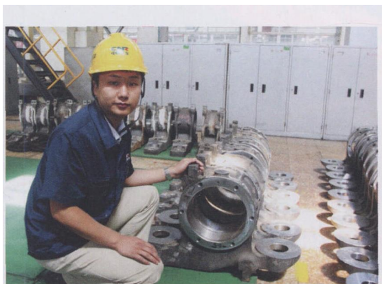
图 1 大同机车机械加工车间技术主管胡智鹏先生展示使用瓦尔特刀具加工的轴箱体部件
