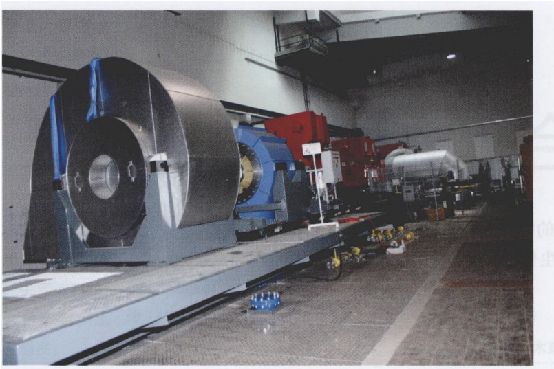
图 2 RGG 风洞中、在新建的 NG-Turb 喷气涡轮机试验台测试中的喷气发动机转子是支承在 Weiss 公司特殊设计的主轴轴承支承系统上的，这也大大地简化了喷气发动机转子的安装和拆卸
