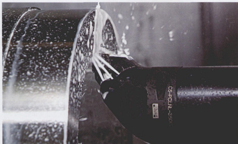
图 1 采用水性氯化钠溶液或水性可溶于水的油作为冷却液
