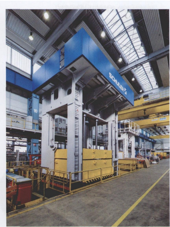
俄罗斯联盟号运载火箭的铝合金零件就是在 Schuler 公司这台压力为 2600 t 的液压机上生产的
