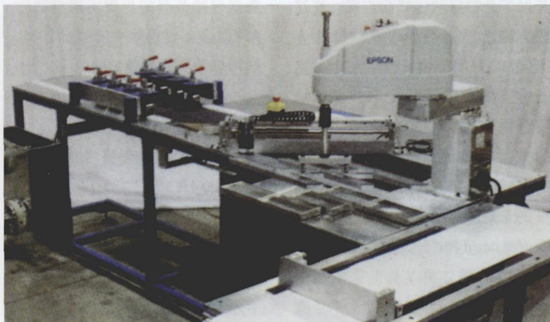
图 1 Accudyne 公司开发了自动化设备，用于将 0° 单向预浸来料卷按 45° 角进行切割，然后将其铺放于衬纸上，形成没有缝合处的 45° 单向带连续卷
