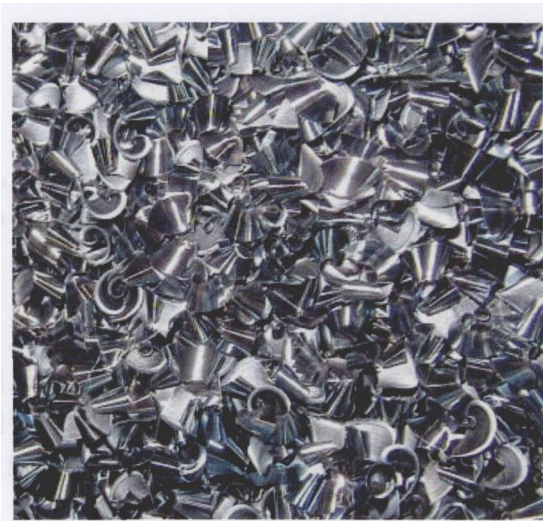
图 4 对于粗加工工序，在整个加工系统刚性允许的情况下，应尽量使其在整个加工过程中产生断屑，尽量采用逆铣方式，使形成的铁屑由厚变薄，并且铁屑形状为“9”字形、“6”字形或“C”字形
