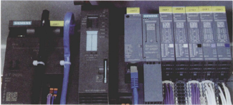
图 3 作为控制装置和颗粒物产品轧制装置的智能化补充，自动化专家采用的分布式系统 Simatic ET 200SP 使用的是 IM151-8 CPU
