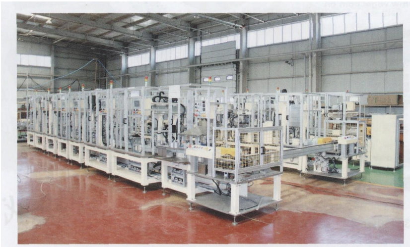
图3 据裴总介绍，这条装配线共由24个工位组成，除了基本采购外，整条线的设计、生产加工到组装，均由绅名科技自行研发完成
