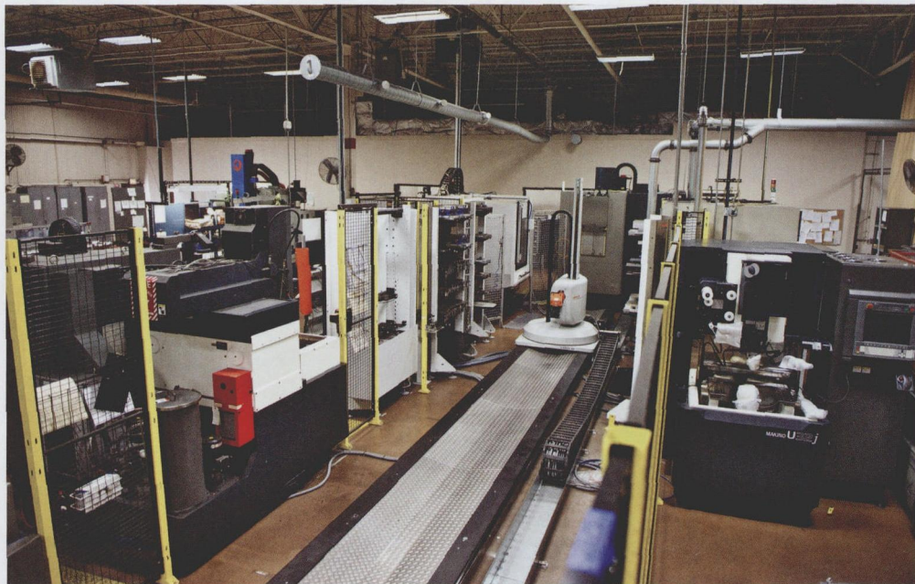
图 1 Strattec 公司先是通过安装一台拾拣机器人 Workmaster Robot 实施自动化过程, 然而单台 Workmaster 只能给电火花机和铣床上料, 为了提高产能, 公司把机器人换成 Workmaster Linear (自动化解决方案), 它可以服务图中的三台加工中心
