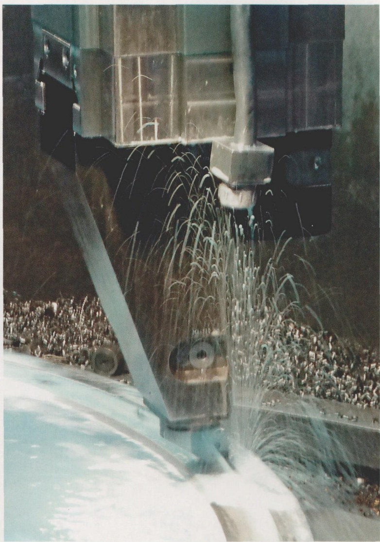
图 1 带有 Coromant Capto 接口的刀具有多种变形刀具；Dörries -Scharmann 车床上使用的是 C8 专用刀具
