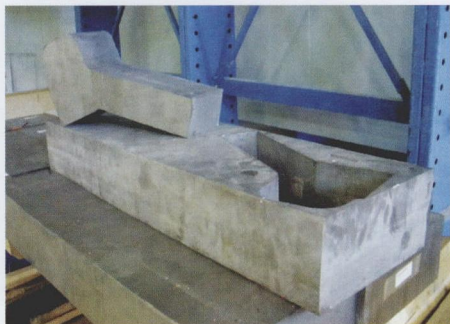
图3 此钛件是6.5in厚粗加工的战斗机起落架组件，相比于粗铣，水切割的剩余坯料具有较高的剩余价值，因为它没有被切成碎屑
