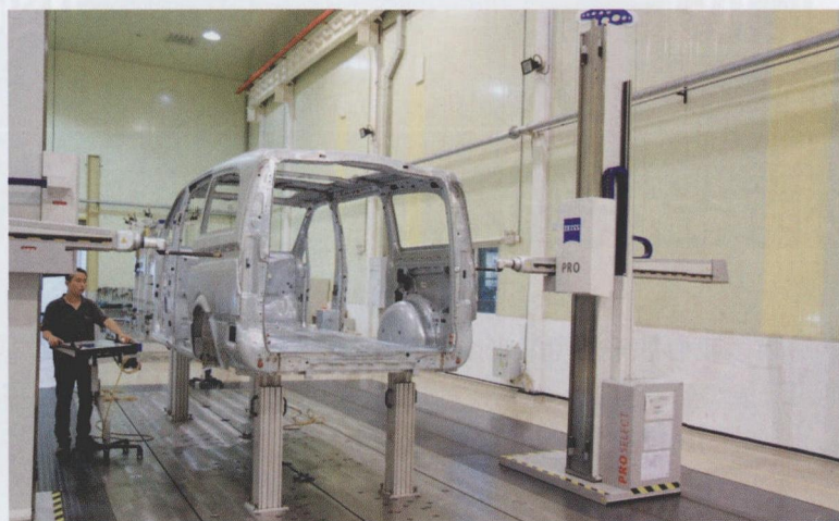
图 2 工程人员正在对白车身进行实际测量
