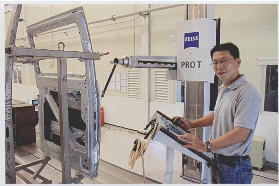
图 1 陈志煌在测量现场表示：“蔡司的悬臂三坐标测量机不仅在尺寸上满足了对大型商务车的测量要求，其测量精度更为我们生产出高品质的商务车起到了保驾护航的作用。”
