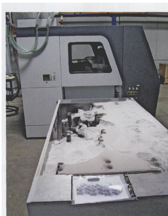
图2 3D砂型打印机在一个周期内可能会运行超过24h,而在这段时间里,它会造出大量的模具组件
