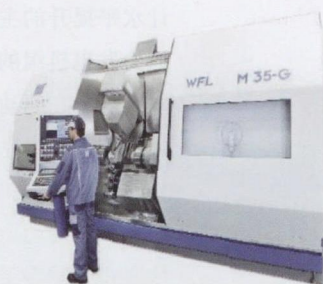
图为 WFL M35-G 型车铣复合加工中心, TopSolid 为用户定制开发后置处理程序。
