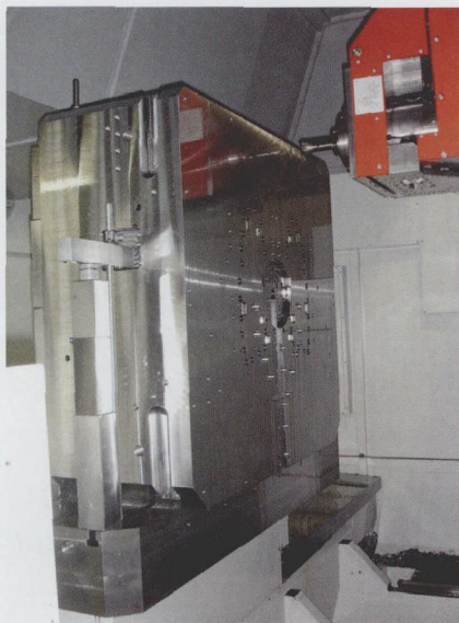
图2 铣切和深钻在一次夹紧时完成,节省安装时间并且在刀具和磨具制造切削加工时省去物流使用
