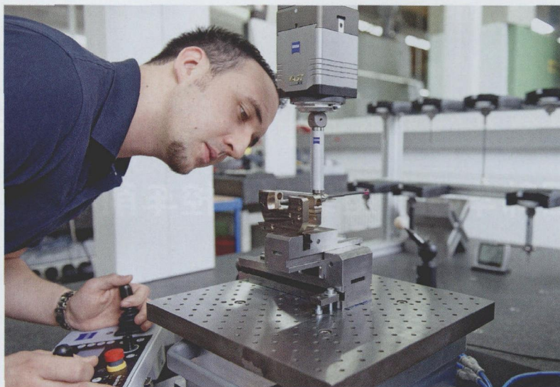
图 3 旋转轴集成扫描测头的龙门测量设备。其量规系统可向任意方向旋转 15^{\circ} 并且总是能够使零件定位在正确的角度
