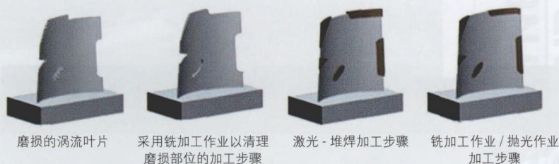
图4 修理涡轮叶片的图解式加工工序
