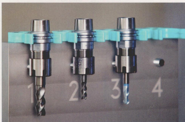
图 2 针对不同的任务做最好的准备：刀具库有 2×4 个位置
