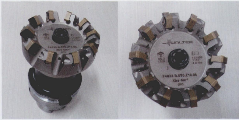
图 3 使用瓦尔特的 F4033 粗铣缸体下结合面，刀具耐用度较原来提高了 30%
