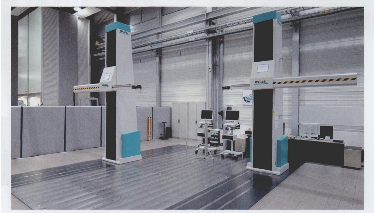
沃尔夫斯堡大众汽车公司的大型 RAX 水平臂式三坐标测量机实现最高精度测量
