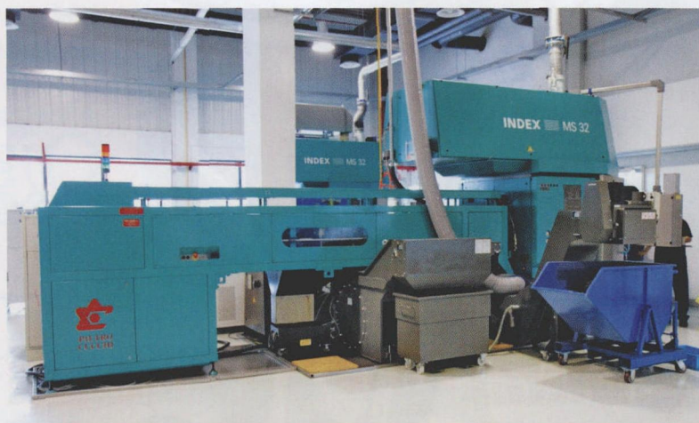
图1 INDEX MS 32 型多主轴机床结合了数控技术的优点和凸轮控制的自动车床的优点
