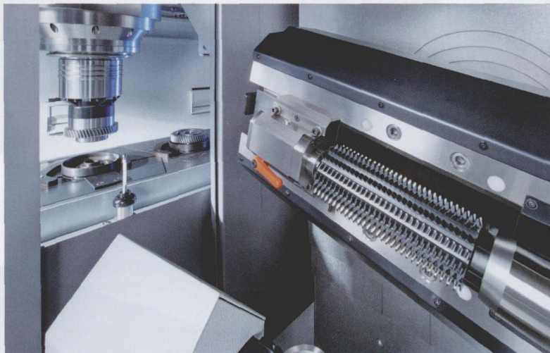
图3 设备可以对 200 mm 以下直径和模数 4 的齿轮进行干式铣削，加工时间很短
