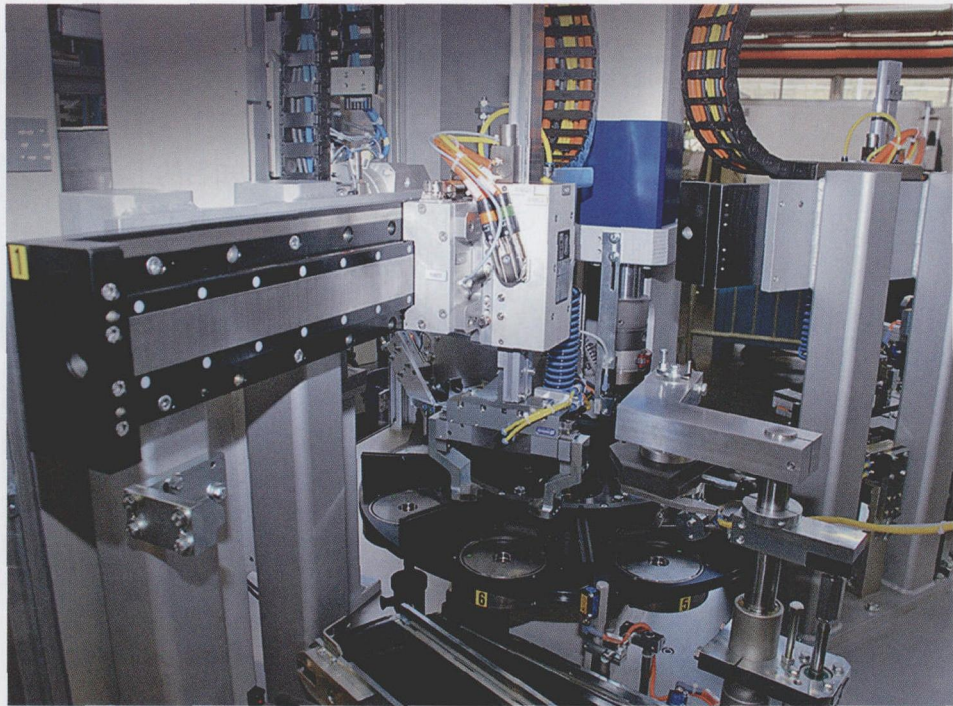
图 1 在用来装配球轴承的灵活装配单元中，两个直线电动机轴进行水平和垂直方向的合作，轴的细长设计是一个优点
