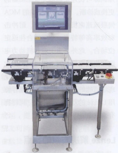
图 2 带两个滑轮的检重秤造型各异，节省占地面积，同时提高了产品通量
