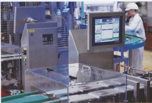
图 3 先进的多轨道检重秤提升了设备总效，从而改善了生产线的质量、效率和可支配性
