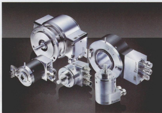
图5 堡盟多圈绝对值编码器利用可靠的非接触感应原理，并采用集成电路来计算圈数。因而编码器非常耐用，甚至可采用大轴径通孔设计
