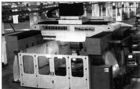
图1 RAMBAUDI公司的RAM—Speed—H45 PLUS型高速加工中心
