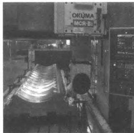
图7 导轨面及连接槽精加工
