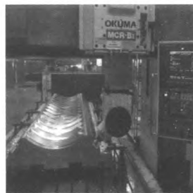
图7 导轨面及连接槽精加工
