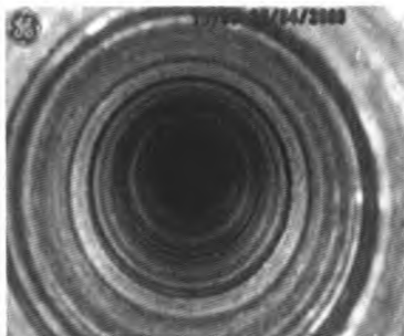
图3 枪钻加工后的孔壁
