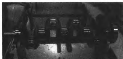
图2 曲轴粗加工阶段的斜油孔加工
