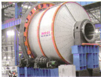
图1 MSZ8848自磨机 (齿圈直径11.6 m,精度等级ISO8级)
