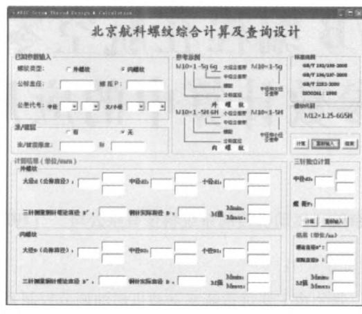
图 2 螺纹参数计算软件界面
