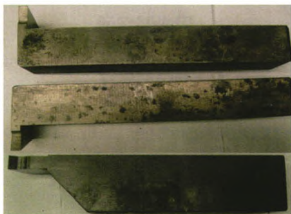
图7 整体式M42高速钢勾槽割刀和直槽割刀
