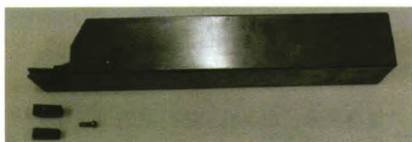
图8 粉末冶金高速钢刀片式槽割刀
