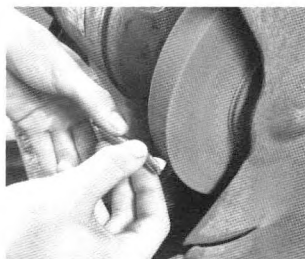
图7 \phi 9.5 mm 键槽铣刀的磨制动作
