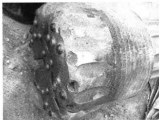
图 1 空气锤钻头边齿脱落
