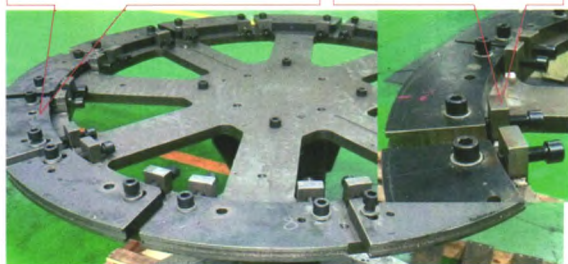
图5 薄壁特易变形的框体类钛合金零件的内衬工装示意（芯部衬托式）
