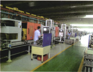
图1 轴承套圈联线生产现场
