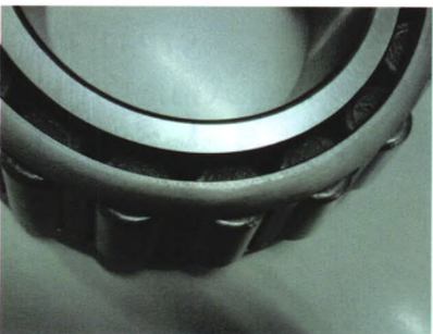
图3 国外滚子小头端面没有磨削加工
