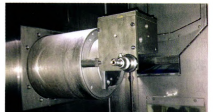
图4 夹具主轴上安装位置
