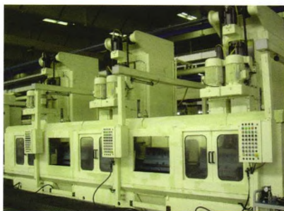
图5 国产缸体缸孔精加工自动线
