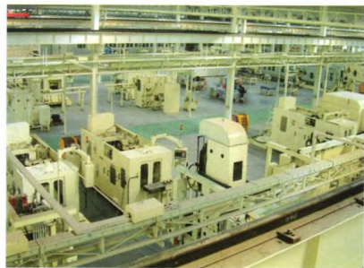
图3 国产缸体柔性加工自动线
