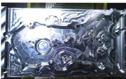
图6 机加工一序加工完图片
