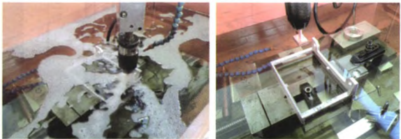
(a) 电火花加工过程 (b) 加工后的现场 图4 电火花加工
