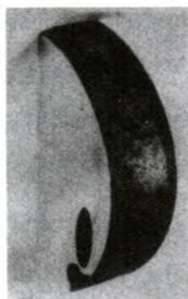
图3 曲轴“C”形裂纹 始于孔壁
