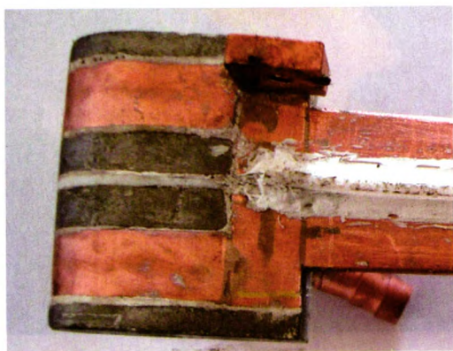
(b) 改进后的结构(中间导磁体分割成两块,中间垫绝缘板)
