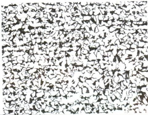
图8 正火后强制风冷的金相组织
