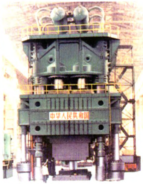
图3 300MN有色金属模锻水压机
