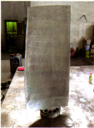
图8 4600叶片的最终精加工状态
