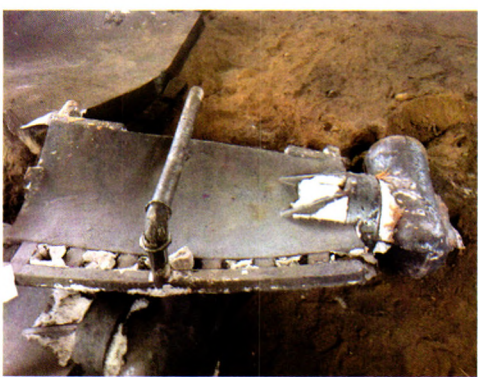
图6 带浇冒口的叶片铸造毛坯
