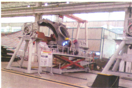
图2 双座式头尾双回转焊接变位机
