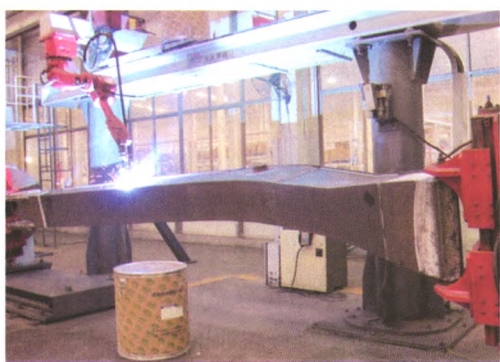
图1 双立柱单回转式焊接变位机
