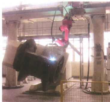
图3 L型双回转焊接变位机
