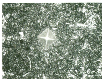
图5 淬火+回火后试件金相形貌 500×
