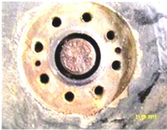
图1 阀杆断口形貌
