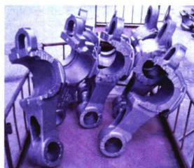
(b) 高铁用低温球墨铸铁件
