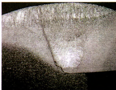
图3 表面有纵向裂纹焊缝横截面试样
