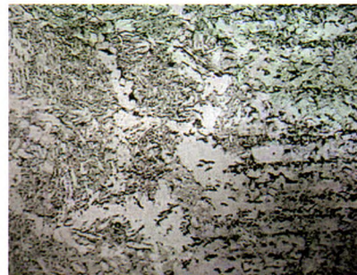
图6 有纵向裂纹基筒热影响区组织
