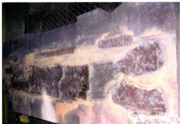
图4 堆焊后的模具
