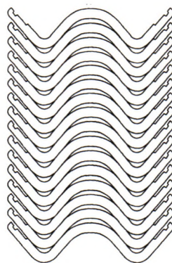
图3 W形上横梁尺寸及排料切割
